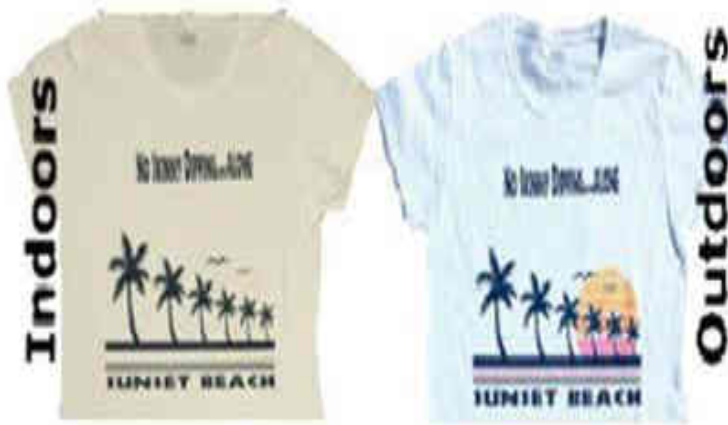
Şekil 1. Baskı yapılan fotokromik boyanın güneş ışığı altında renk değiştirmesi (www.solaractiveintl.com, 2016)
