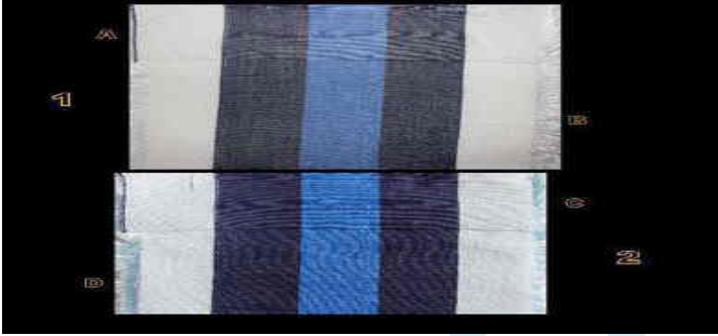
Şekil 2. Fotokromik iplikle dokunmuş kumaşta ışık ile renk değişimi (Bilir M. Z., 2016)
