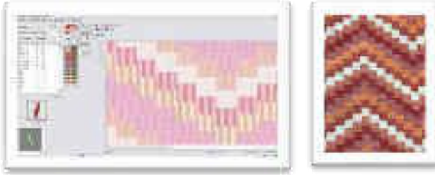
Resim 2: Ned Graphics Programının jakarlı dokuma modülünde çalışılmış örgüleştirme - simülasyonu ve üretilmiş kumaş örneği (Aytül Apalak arşivi)
