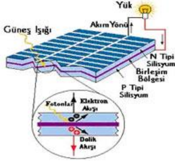
Şekil 6. Güneş Pili yarı iletken yapısı [10]
