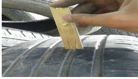
Şekil 2. Ömrünü tamamlamış lastiklerde dış derinliği ölçümü
