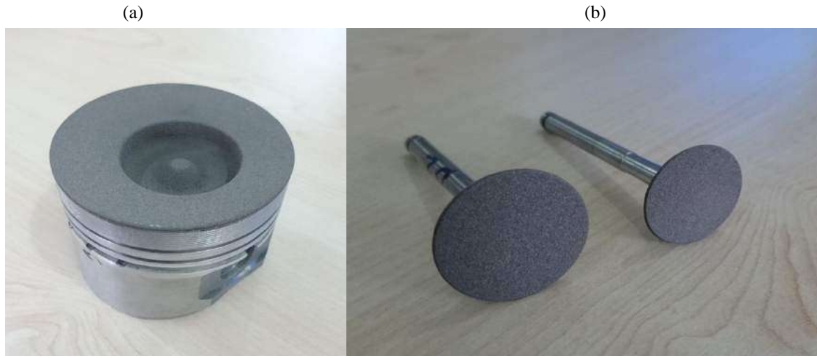
Cr_2O_3 kaplanmış piston (a) ve supaplar (b)
