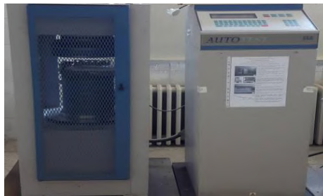
Şekil -3. Otomatik yükleme hızı kontrollü pres
