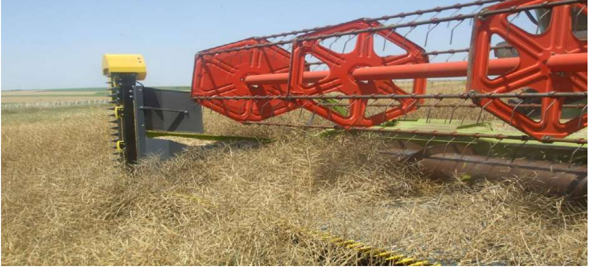
Şekil 5. Motorlu Tip Kanola Hasat Tablası ile Deneme Tarlasından Görünüm
