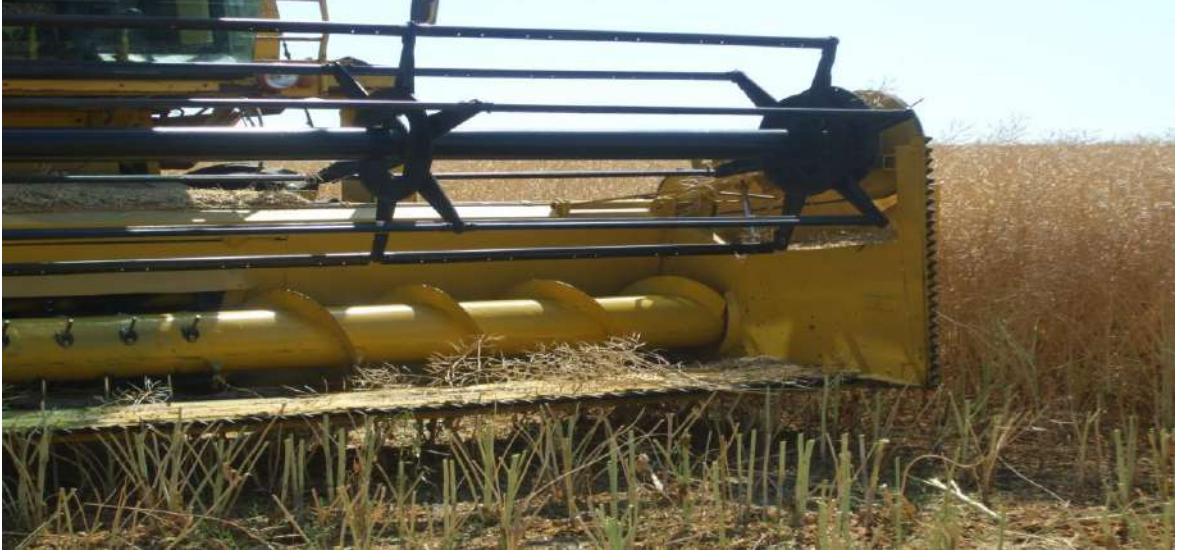
Şekil 7. Mekanik Tip Kanola Hasat Tablası İle Deneme Tarlasından Görünüm
