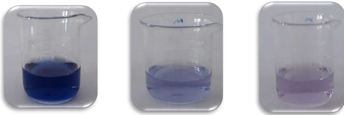
Şekil 9. Reaktif Black 5 boyasının biyosorbent maddeler (KA ve KAD) ile etkileşimi sonucu boyada meydana gelen değişimler
