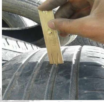
Şekil 2. Ömrünü tamamlamış lastiklerde diş derinliği ölçümü
