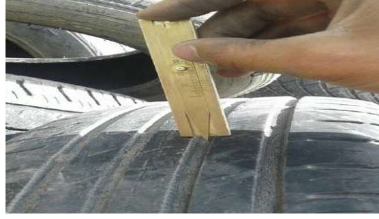
Şekil 2. Ömrünü tamamlamış lastiklerde dış derinliği ölçümü
