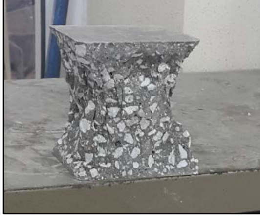
Şekil 3. Deneyde elde edilen kırılma örneği.
