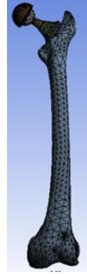
Şekil 5. Femur ve Kalça Protezi Mesh Modeli.
