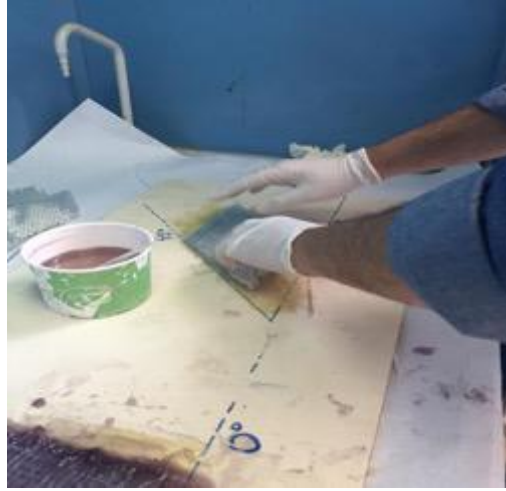
Şekil 2. CETP Kompozitin Dökümü.
