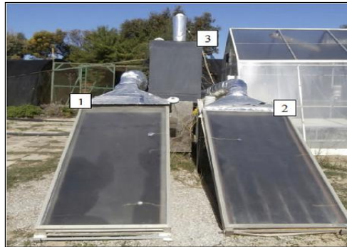
Şekil 12. 1) Güneş Enerji Akümülatörü 2) Havalı Güneş Kollektörü 3) Kurutma Odası.
