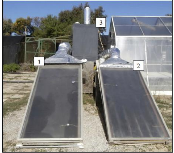
1)Güneş Enerji Akümülatörü 2) havalı güneş kolektörü 3 ) kurutma odası
